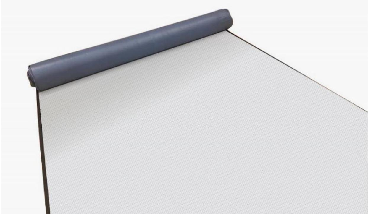
CANVAP S est une membrane pare-vapeur autocollante utilisée dans les systèmes de toiture et de murs isolés. Composée d'un tissé de polyéthylène trilaminaire en surface, d'un film siliconé détachable sur la sous-face et d'un adhésif à base de polymères permettant une application sans apprêt même en températures froides.
